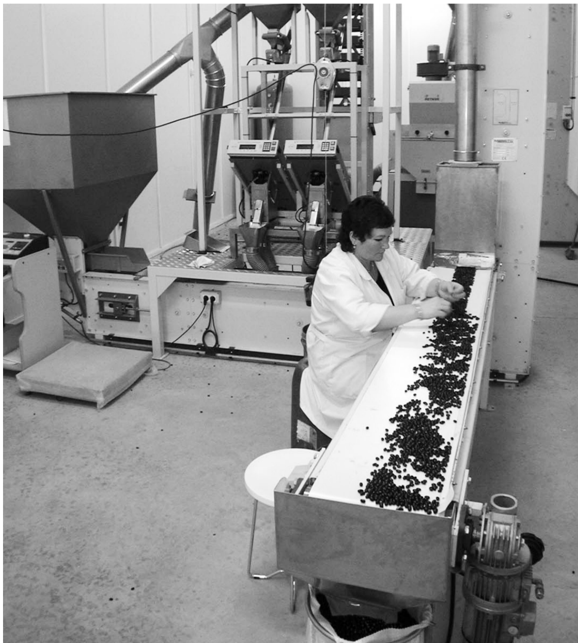
Tolosako Babarruna elkarteak babarrunak aletzeko makina bereziak erabiltzen ditu.
