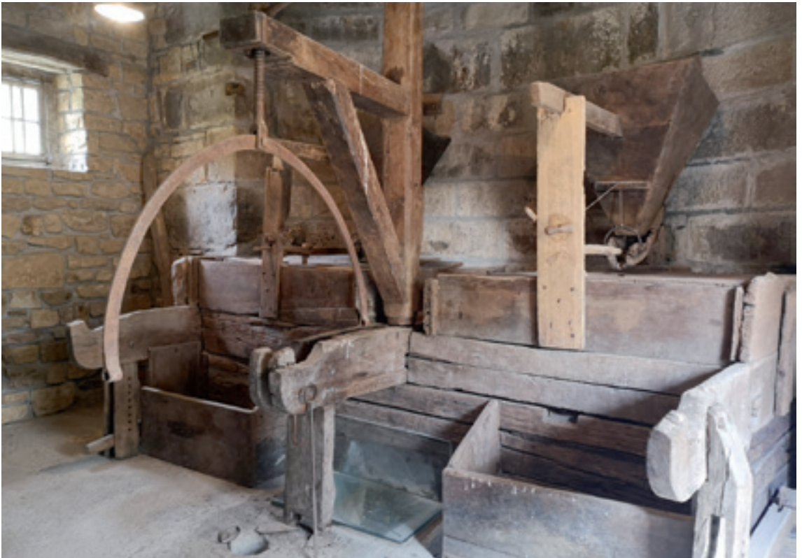
Elorreta errotako bi harriak, eta horien pitzadurak konpondu ahal izateko harriak kentzeko erabilitako tresneria.
