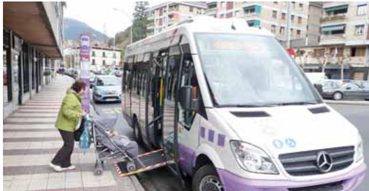
Hiri autobusa Otalora kalean, ume-kotxe batendako plataforma jaitsita. | J.B.
